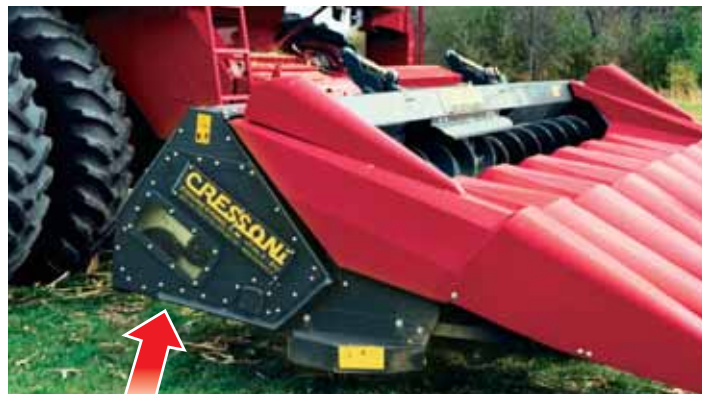
Боковые цепи передачи находятся в масляной ванне.
