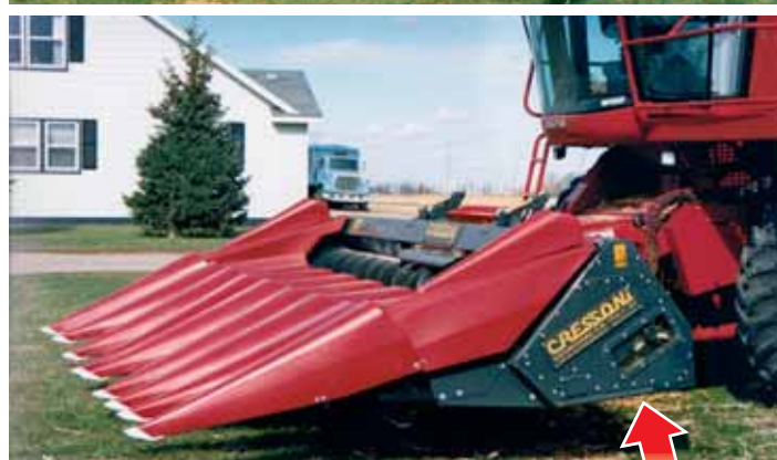
Боковые цепи передачи находятся в масляной ванне.
