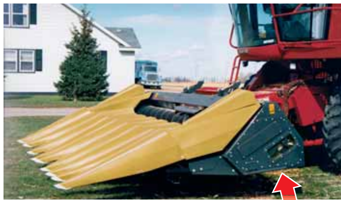
Cadenas de transmisión laterales en baño de aceite.
