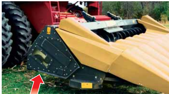
Cadenas de transmisión laterales en baño de aceite.
